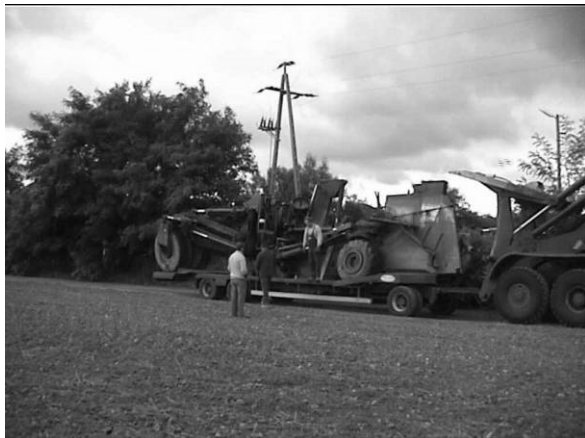
Rysunek 18. Pługoukładacz na platformie transportowej.
