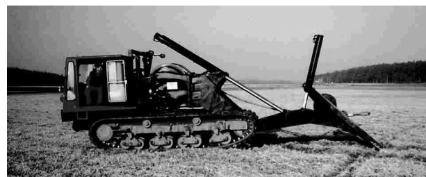
Rysunek 13. Wciągarka linowa zabudowana na ciągniku gąsienicowym
