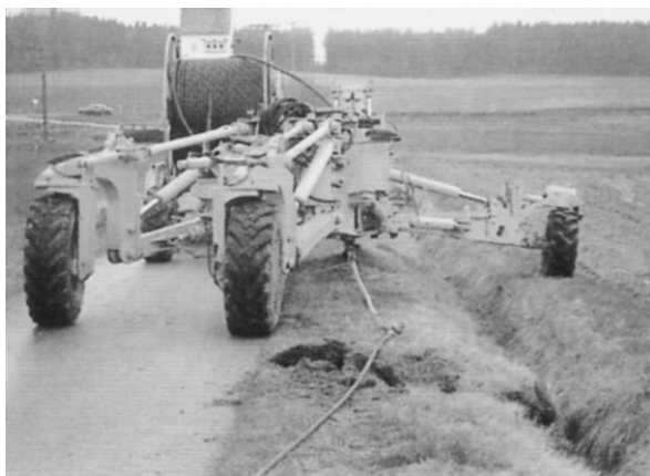
Rysunek 9. W pługoukładaczu przedstawionym na zdjęciu pozycja każdego koła jest ustawiana indywidualnie – pozwala to na układanie rurociągów i kabli w różnych warunkach ukształtowania terenu.
