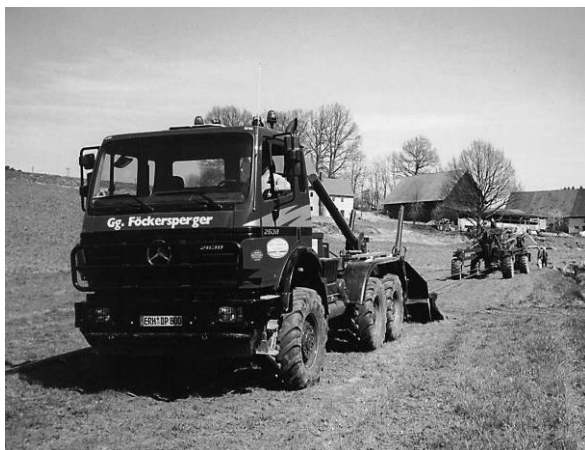
Rysunek 12. Wciągarka linowa zabudowana na ciągniku kołowym.
