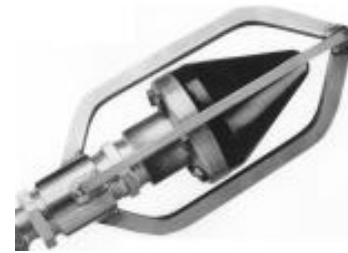
Rysunek 5. Głowica czyszcząca z zamontowanym elementem dystansowym [5].
