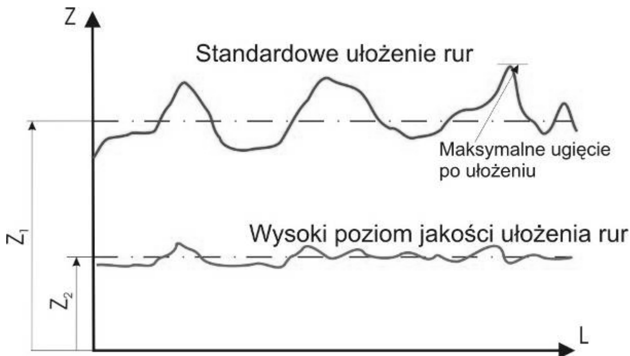
Rysunek 4. Typowe zmiany ugięcia Z wzdłuż rurociągu L dla dwóch poziomów jakości ułożenia [7] Z_1 i Z_2 – średnie ugięcie po ułożeniu
